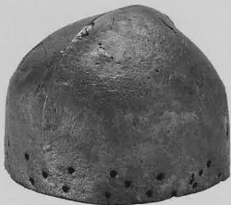
Sl. 4a, b – Kotlasta avba iz 14. stoletja, najdena v Ljubljani. Metalografska analiza je razkrila, da je bilo pokrivalo izdelano iz delno kaljenega jekla (hrani Narodni muzej Slovenije, foto: T. Lauko, A. Williams).
